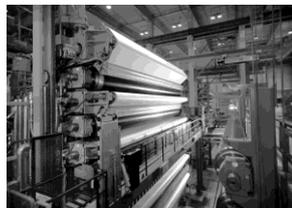
ここで、スーパーカレンダーの典型的な運転条件を紹介します。通常では 100 度以下の低い温度で操業されています。ニップ数は、7 段から 16 段、一般的なものは 11 ニップです。速度は 500m/分から 1,000m/分。ボトムニップで最大 450 kN/m、そのときにトップで形成されるのが 250 kN/m です。スーパーカレンダーではファイバー、コットンロールが使用されていますが、最近では樹脂ロールに変わりつつあります。
